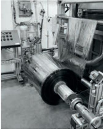
*Ein einzigartiger, hochdramatischer Effekt von METALURE® Liquid Black – ermöglicht durch ein besonders aufwendiges Metallisierungsverfahren. Nach dem Aufdampfen von Chrom auf die Folien und aufgerollt auf Spulen wird das Metall zum Schluss wieder auf Pigmentgröße zerkleinert und kann dann Farben und Lacken hinzugefügt werden.*
