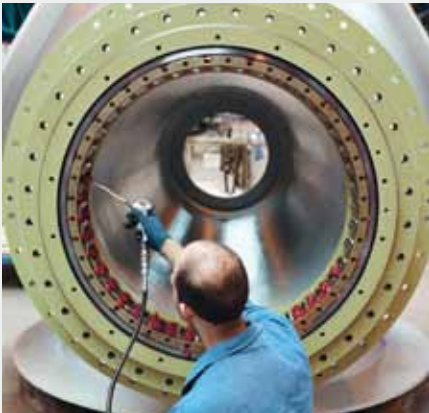
Vorbereitung des isolierten und imprägnierten Generators für eine Windenergieanlage
