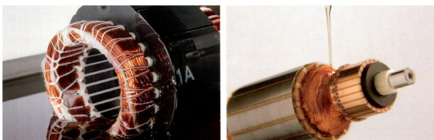
**Beispiel Sekundärisolierung:** Die Applikation von Harz durch Tauchrollieren oder Träufeln ist eine schnelle und effiziente Methode zur Tränkung verschiedener Arten drahtgewickelter Objekte, wie z.B. Statoren oder Rotoren. Bei diesen Anwendungen wird das Harz in Kombination mit dem applikativen Prozess sorgfältig ausgewählt, um einen hohen Grad der Durchtränkung, eine hohe Harzaufnahme der Wicklung und bestmögliche Verfestigung zu erreichen.
