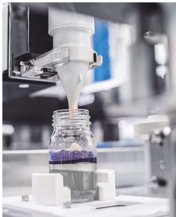
Exakt dosiert: Bis aufs Milligramm genau wiegt der Dosierkopf Feststoffe wie Pigmente, Füllstoffe und pulverförmige Additive und gibt sie über die Kartuschen ins Probengefäß. Foto: Byk
