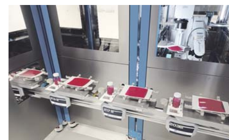
Schicht für Schicht: Der fertig angerührte Lack wird auf Glas, Blech oder Karton aufgetragen. Nach der Trocknung erfolgt der Qualitätscheck mithilfe modernster Prüftechniken. Foto: Bettina Reckter
