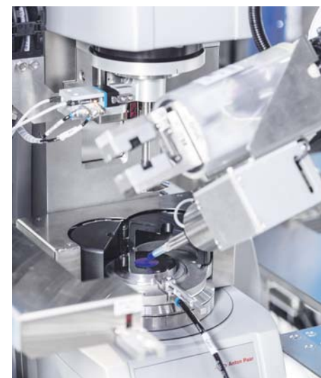
Messen: Beim Auftragen der Probe dürfen die rheologischen Eigenschaften nicht durch Scherkräfte beeinflusst werden. Foto: Byk
