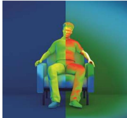
Der Wärmetest zeigt: Herkömmliche Farben (links) lassen den Körper schneller auskühlen als Ireflex-Farben (rechts). FOTO: ALTANA AG
